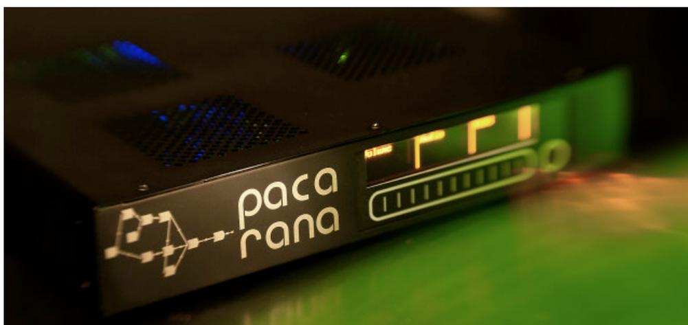
システム構成は、プログラムを走らせるPCと前述した外部接続のDSPユニット、及び USB/IEEE1394 ケーブルでDSPユニットとチェインされたAD/DAを組合せたものになります。入出力数はAD/DAの仕様に準拠しますが、扱える音声チャンネルは最大で8chまでとなっています。
